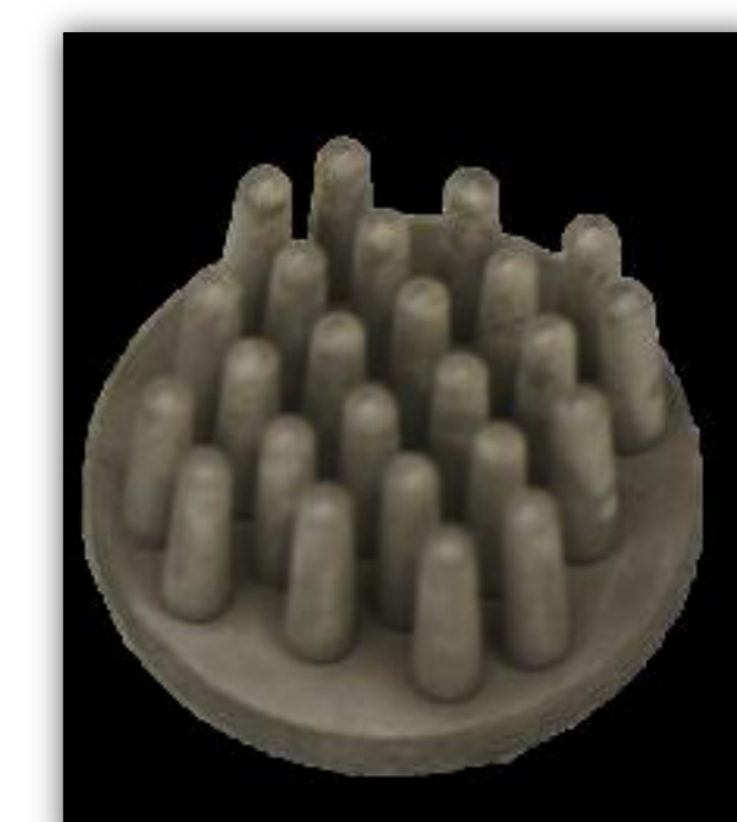
Elettrodo a secco multi-pin su base di poliuretano e rivestimento di Ag/AgCl.
