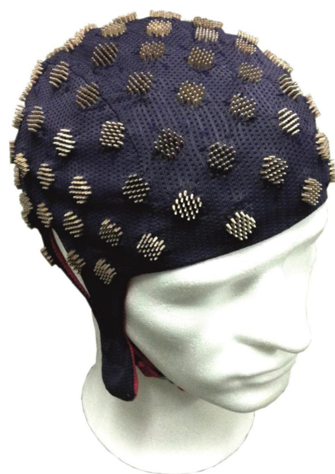
Prototipo di cuffia con 97 elettrodi a secco multi-pin su base di poliuretano e con rivestimento di Ag/AgCl.
